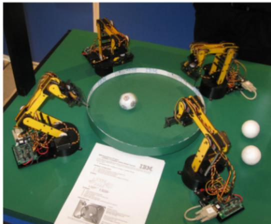
IBMs Studentenprojekt SpeedTeam steuert mit dem Blade-Server Fußballroboter per Kamera.
